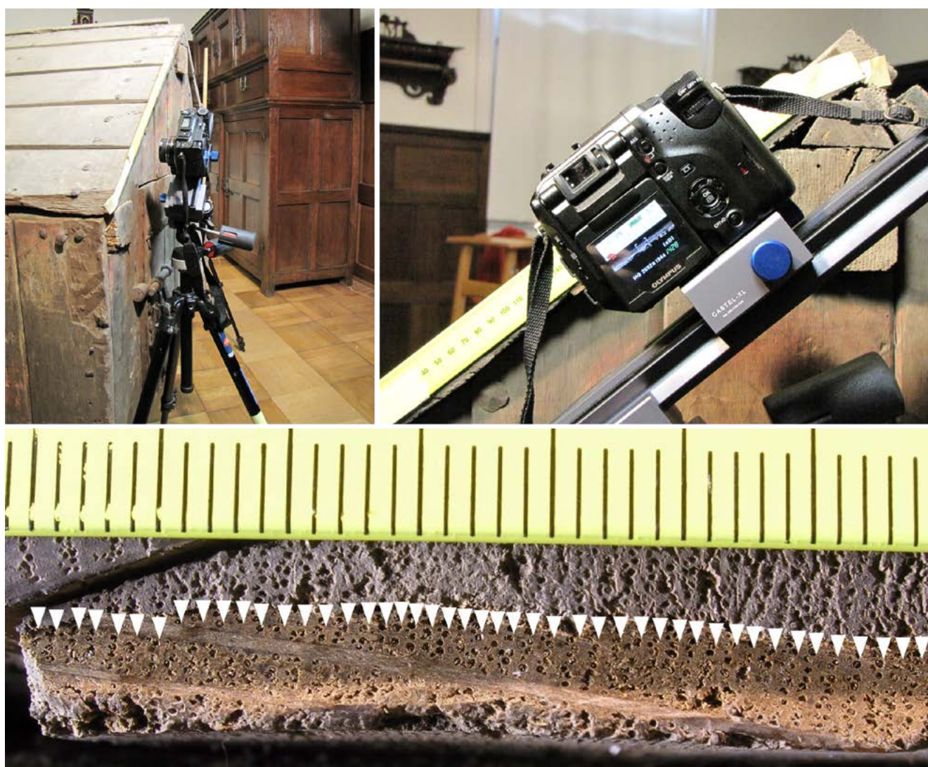
FIG 18 Macro-fotografie om het jaarringpatroon op een plank van een middeleeuws reliekschrijn te registreren. Een schaallat wordt mee in beeld gebracht om de opnames achteraf te kunnen kalibreren. De witte driehoeken markeren de overgang tussen twee opeenvolgende jaarringen.
