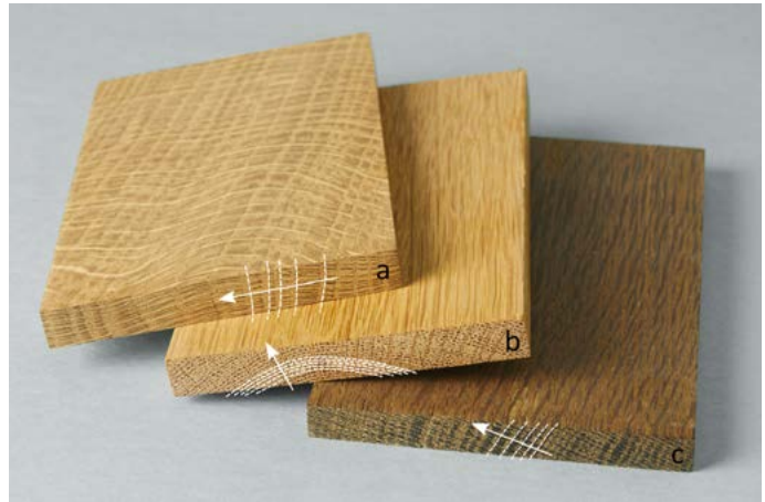
FIG 8 Drie plankjes uit eikenhout. (a) Snel gegroeid eikenhout met brede jaarringen. Dit stuk is 'kwartiers' gezaagd (= loodrecht op de jaarringen). Op het radiaal vlak zijn glanzende 'spiegels' te zien. Dit zijn de houtstralen die overlangs worden aangesneden. (b) Traag gegroeid stuk eikenhout met heel smalle jaarringen. Deze plank is 'dosse' gezaagd. (c) Een stuk subfossiel eikenhout met een gemiddelde en regelmatige groei. De pijlen wijzen in de richting van de bast.
