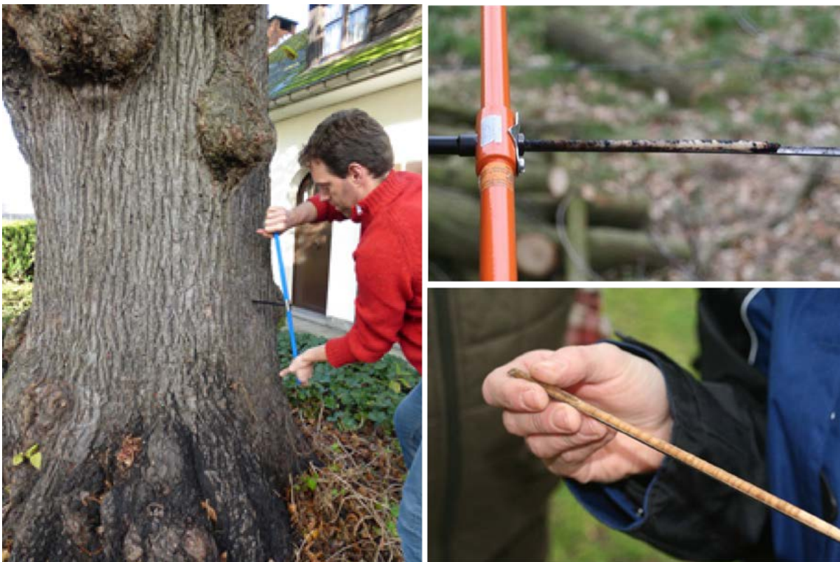
FIG 19 Staalname van een levende, monumentale linde met behulp van een Pressler-boor. Op de boorkern zijn de jaarringen na drogen en opschuren of bijsnijden af te lezen.
